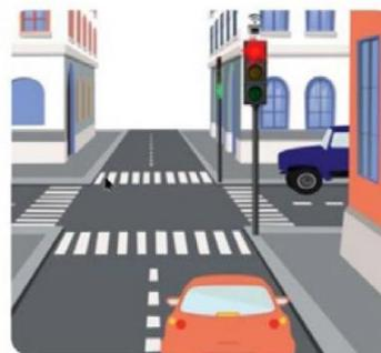
Le capteur détecte l'arrivée d'un véhicule: LE FEU NE PASSE PAS AU VERT, car un autre usager (véhicule ou piéton) est arrivé en premier à l'intersection.
