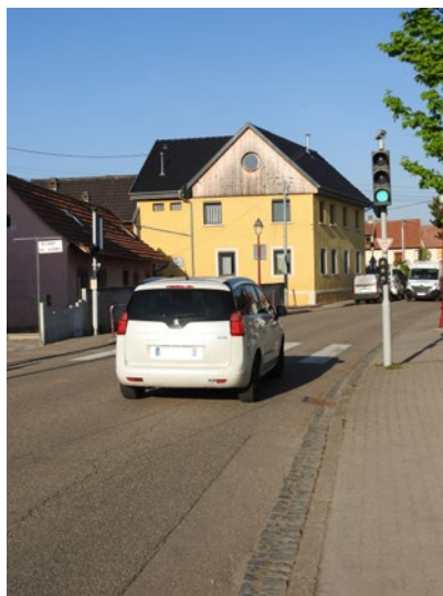
Passage au vert car véhicule détecté en l'absence de piéton
